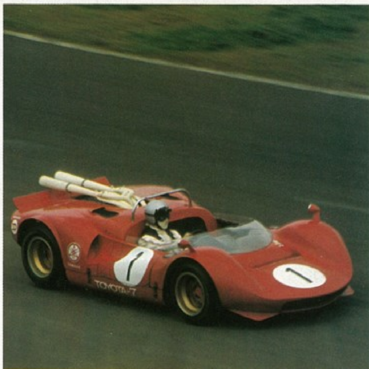
トヨタ7。V8DOHC3000cc、デンソー製燃料噴射装置付。シャシーはアルミ軽量モノコック、ボディはFRP製。
