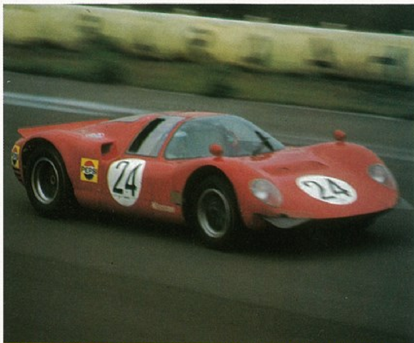
ニッサンR380-II。直6DOHC24バルブ1996cc 燃料噴射装置付、220馬力。ミッションはZF5速。ブレーキはガーリング製。
