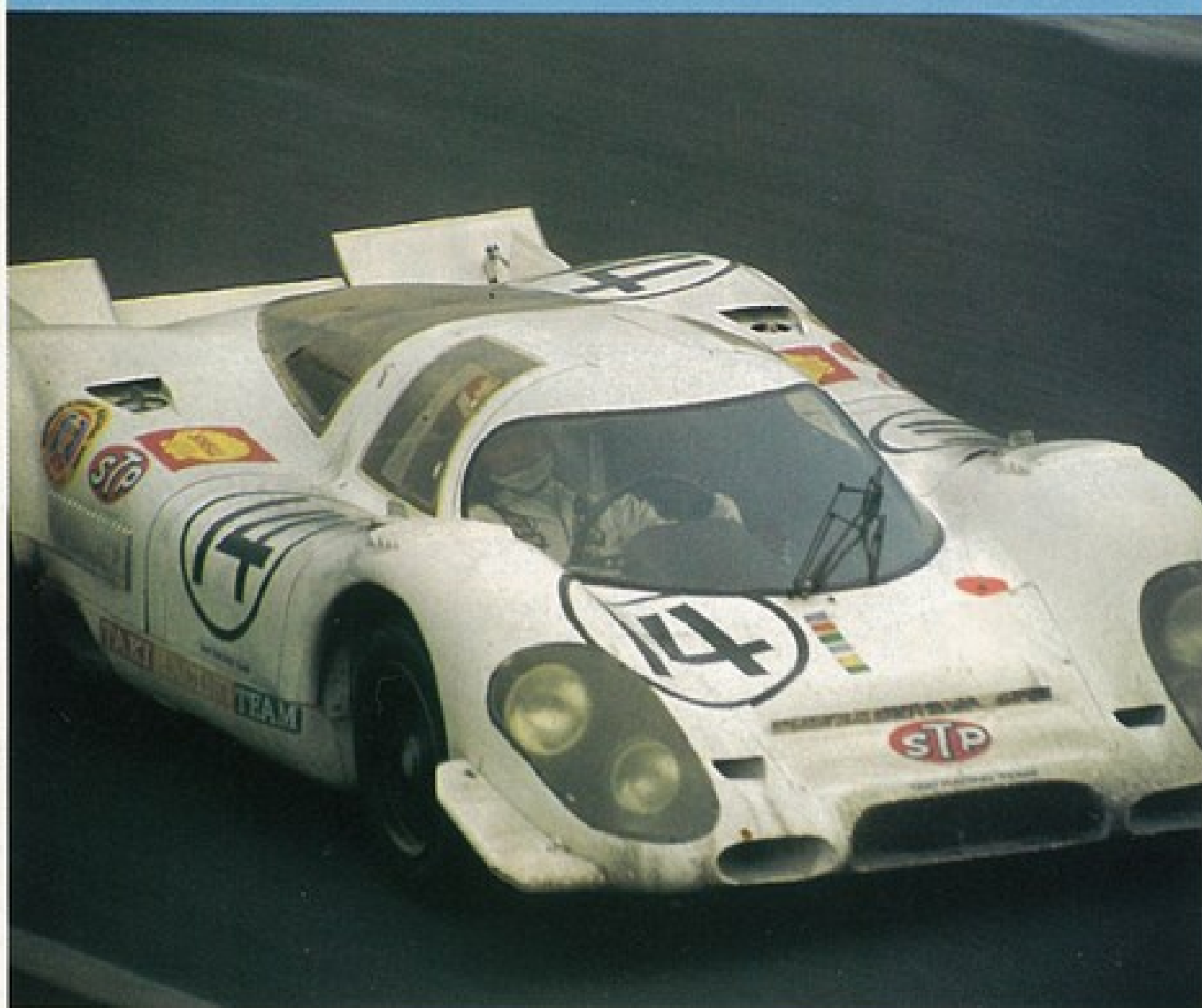
ポルシェ917。空冷水平対向12気筒DOHC24バルブ、4494cc、500馬力を発生。
