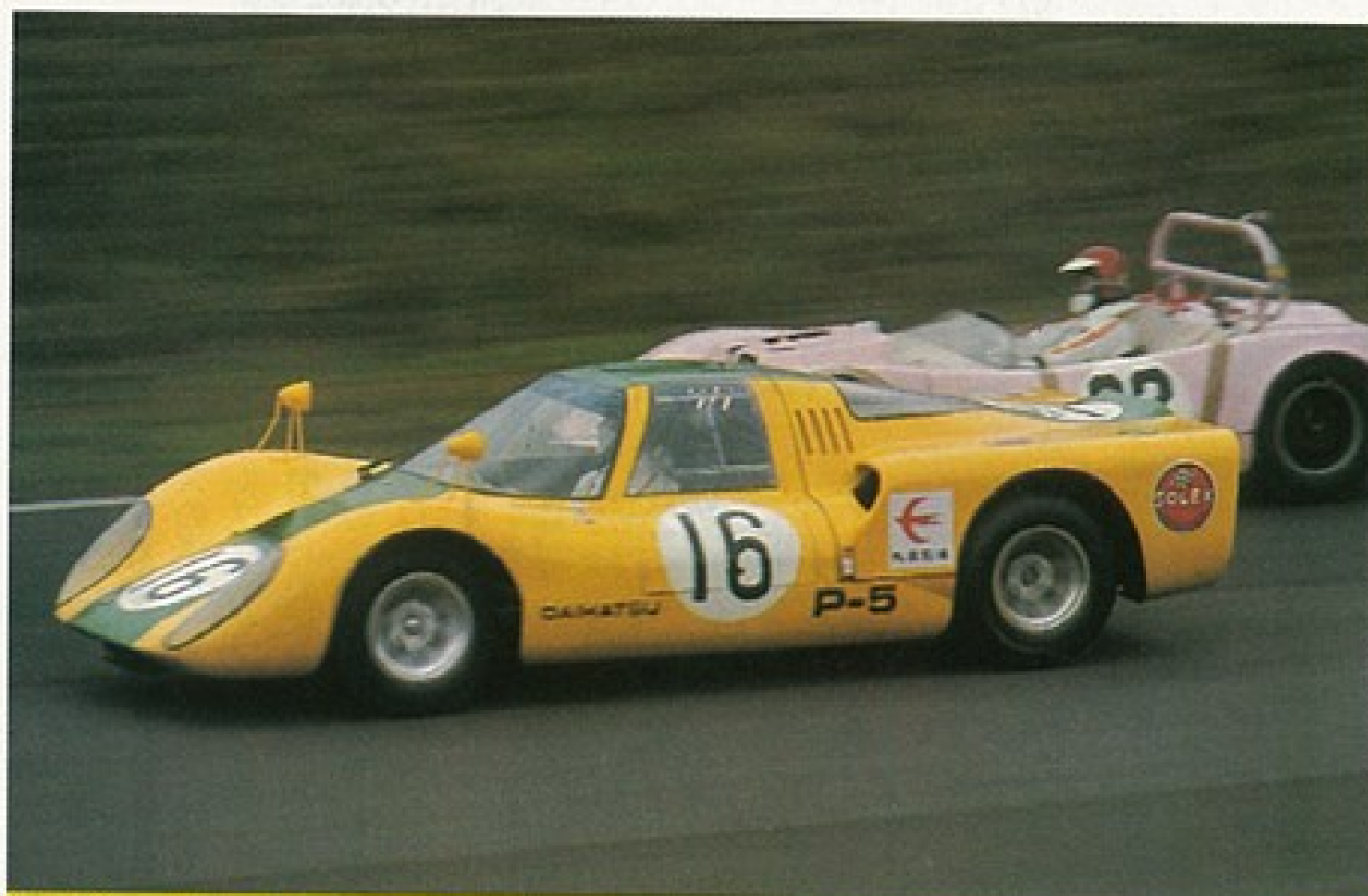
ダイハツP-5。DOHC16バルブ1261cc、ソレックス2連×2基、130馬力/8000回転。
