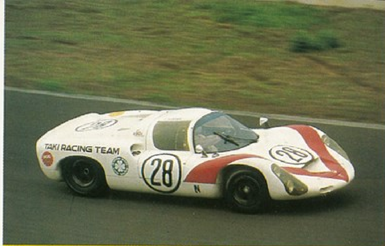
ポルシェ・カレラ10。SOHC水平対抗6気筒1991cc、ポッシュ燃料噴射装置付、220馬力/8100回転、最高速は340km/hでゼロヨン9.8秒。
