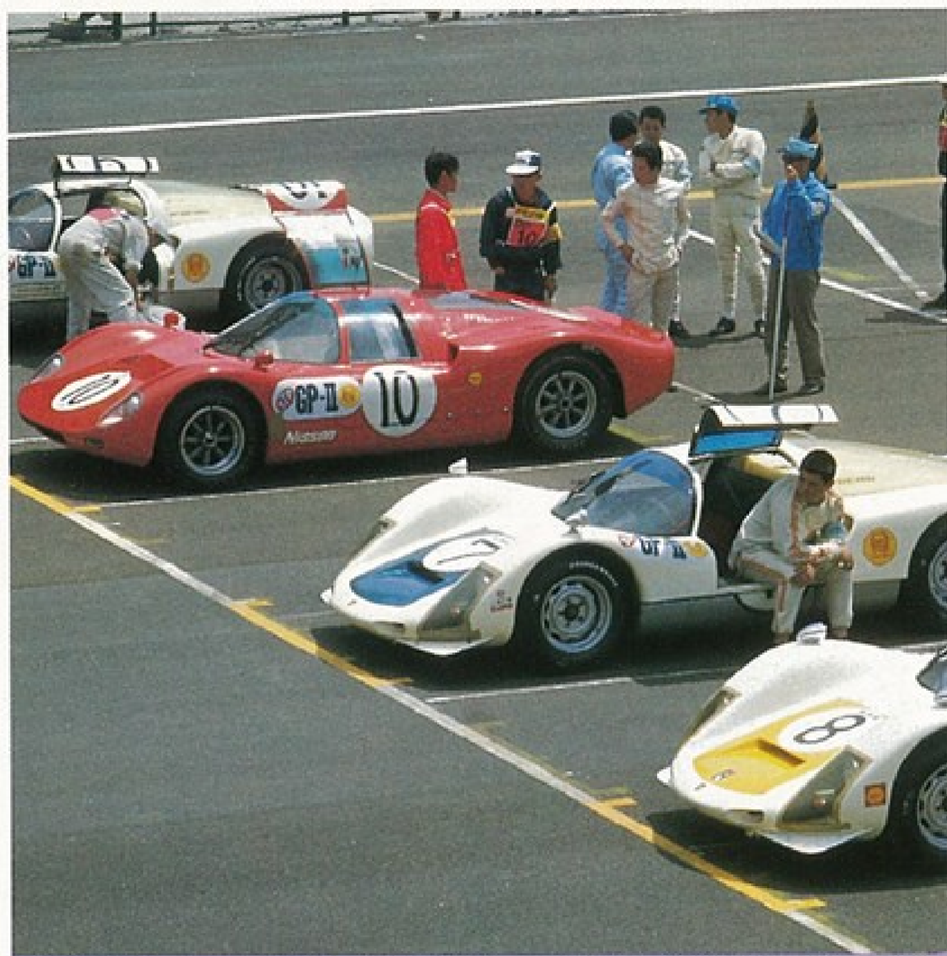
②&③ボルシェ・カレラ6。SOHC1991cc、210馬力/8200回転、20kg/6000回転。④三ツサンR380-II。DOHC1996cc、220馬力以上。
