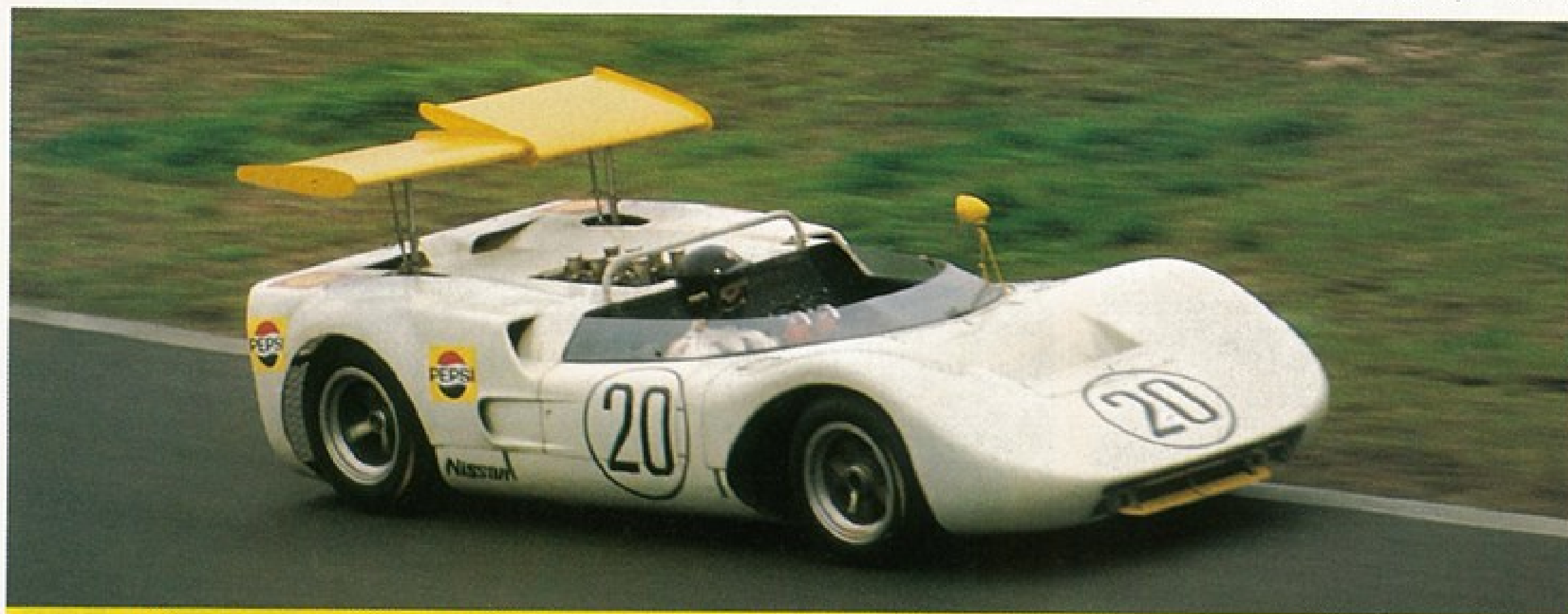
ニッサンR381。シボレーV8、OHV5461cc、ウェーバー・ダウンドラフト・ツインチョーク4基、450馬力以上。最高速は320km以上。
